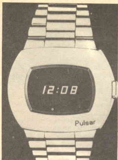
Il Pulsar completamente elettronico (della ditta Hamilton, HMW Industries) indica il tempo analogicamente con diodi emettitori di luce che vengono messi in funzione premendo un bottone.
