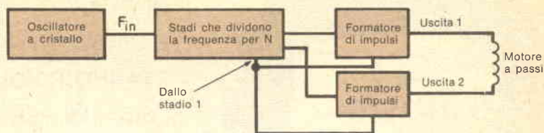
Fig. 1 - Schema a blocchi semplificato di un tipico orologio da polso elettronico con lancette tradizionali. Il circuito può essere usato per comandare un motore a passi, un motore sincrono ed un bilanciere. In ogni caso, il motore o il bilanciere fanno muovere le lancette situate su un normale quadrante di orologio.
