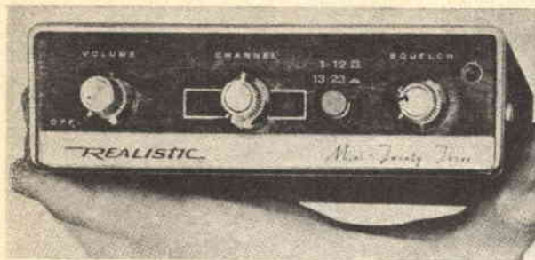
Il Radio Shack "Mini 23" è un apparecchio da 5 W con prestazioni complete, ma che può essere riposto con facilità nel cassetto del cruscotto dell'auto.
